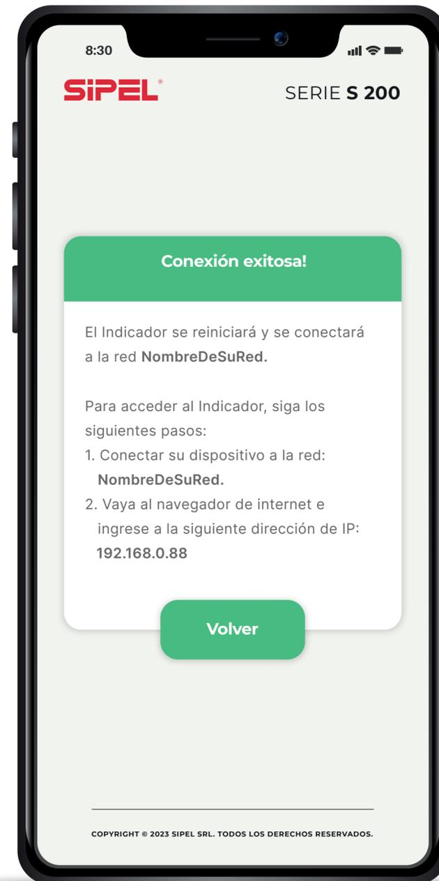
Una vez que el S200 se conecte exitosamente, se devolverá un mensaje de confirmación de la conexión, que contendrá el número de IP que se le ha asignado al indicador (lo llamaremos IP-ASIGNADA, en este ejemplo 192.168.0.88).
